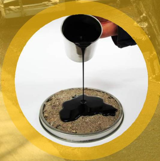
*MC-30 es una mezcla de cementos asfálticos con solventes hidrocarbonados volátiles destilados del petróleo, que provee al asfalto diluido un tiempo de curado medio. Su aplicación en los riegos de superficies es homogénea gracias a su consistencia.*
